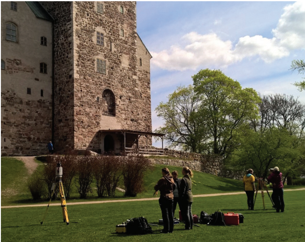
Kuva 1. Helsingin yliopistossa järjestetyn laserkeilauskurssin opiskelijat tekevät mittauksia Turun linnalla. Käytössä ovat sekä laserkeilain että takymetri, joita molempia tarvitaan Raumalla käytetyssä dokumentointitavassa. Kuva: K. Uotila.
