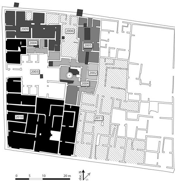
Kuva 3. Korttelin pohjakaava ja erillisten rakennusten rajat. Kuvassa näkyvät myös projektin aikana paikalleen mitatut rakenteet. (Piirtänyt: M. Holappa.)
