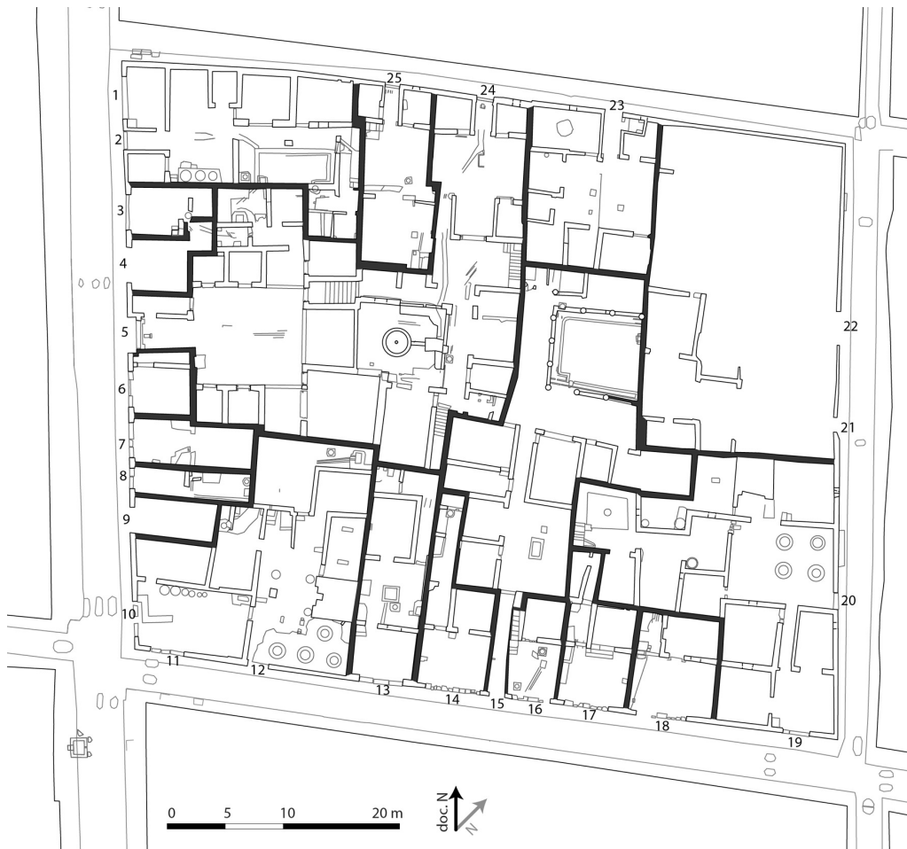
Kuva 3. Korttelin pohjakaava ja erillisten rakennusten rajat. Kuvassa näkyvät myös projektin aikana paikalleen mitatut rakenteet. (Piirtänyt: M. Holappa.)
