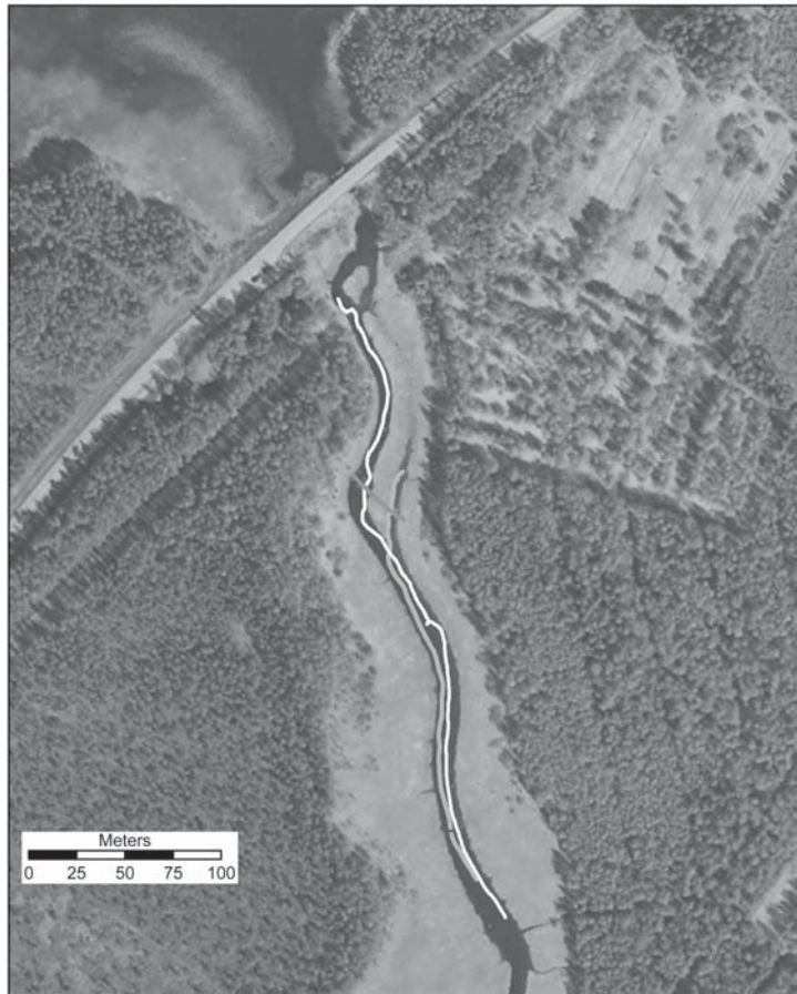
Kuva 2. Nimisjoen yläosan lapinpadon prospektoinnin mittauslinjat ortoilmakuvassa. Pitempi pohjois-eteläsuuntainen mittauslinja on 358 m ja lyhyempi suunnaltaan vastakkainen umpeenkasvaneeseen uomaan päättävä linja 223 m pitkä. Viistosti joen yli kulkeva poikkiviiva merkitsee lapinpadon paikkaa. Ortokuva: © Maanmittauslaitos, ortokuva-aineisto 2010.
