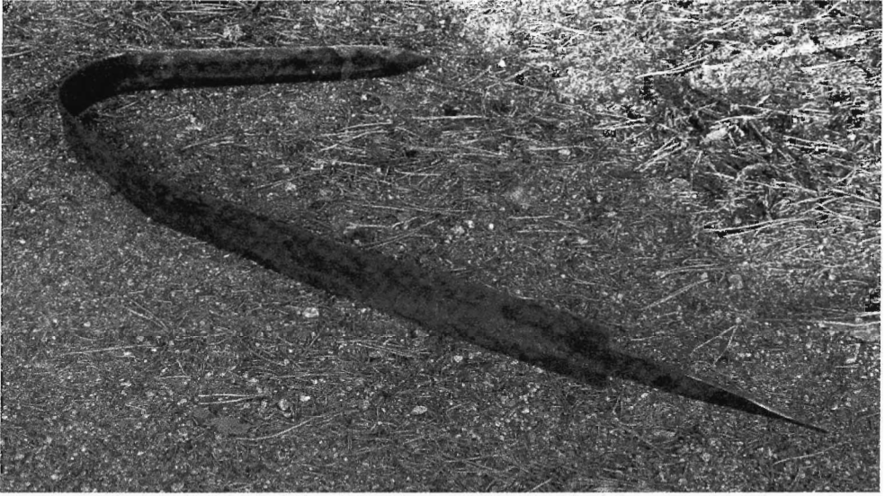
Kuva 5. Kokonaan teräksinen säilä, joka on kuumennettu hieman yli kolmensadan asteen ja taivutettu sen jälkeen kylmänä. Kiillotetun säilän pinta on väriltään tummanharmaa, mutta palopatinaa ei alhaisen lämpötilan vuoksi syntynyt. Kuva: Mikko Moilanen.
