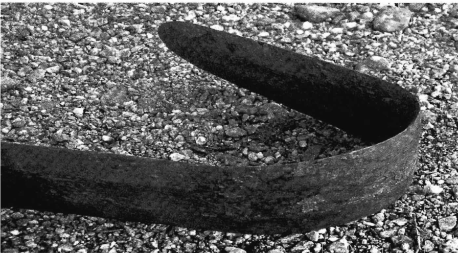
Kuva 4. Polton jälkeen kylmänä taivutettu kuvioteräksinen miekansäilä. Taitoskohdassa on edelleen palopatinaa jäljellä. Kuva: Mikko Moilanen.
