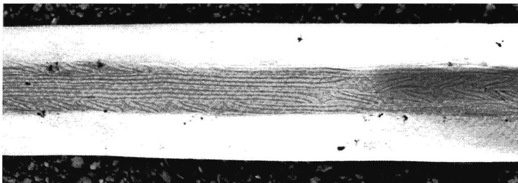
Kuva 3. Lähikuva kokeissa väännellyn kuvioteräksisen säilän kuvioista. Kuva: Mikko Moilanen.
