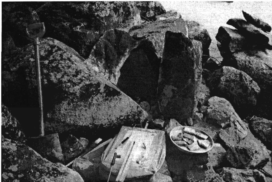
Kuva 1. Polttokokeessa käytetty hiiliuuni avattuna polton jälkeen. Etualalla palkeet, joilla puhallettiin ilmaa savella vuoratun uunin pohjalle
