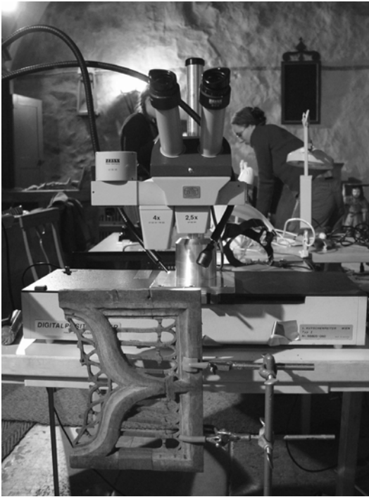
Kuva 1. Vuosilustojen mittaaminen lustomikroskoopilla Rymättylän kirkon veistoskaapin osan pinnasta.
